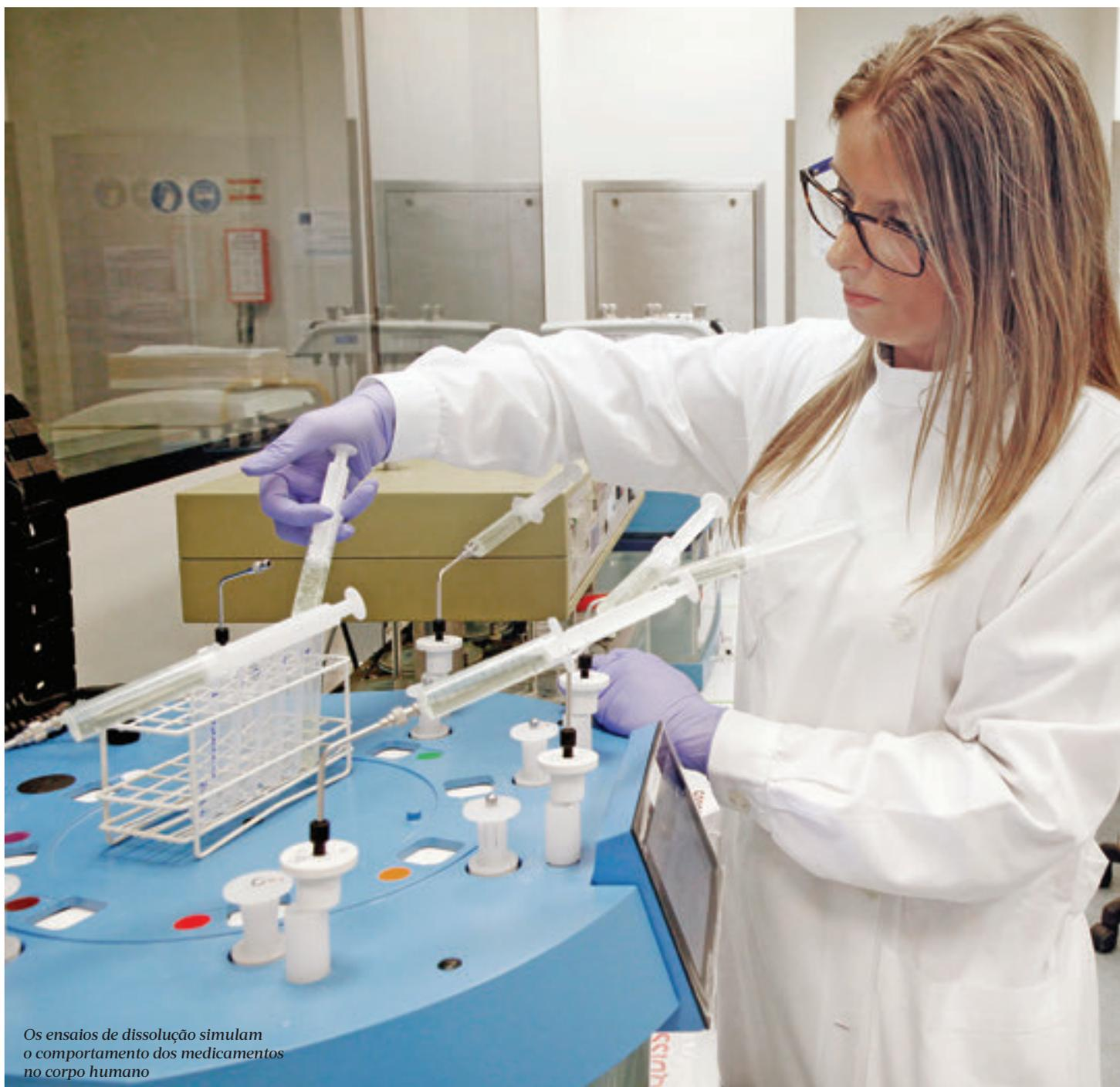
*Os ensaios de dissolução simulam o comportamento dos medicamentos no corpo humano*
